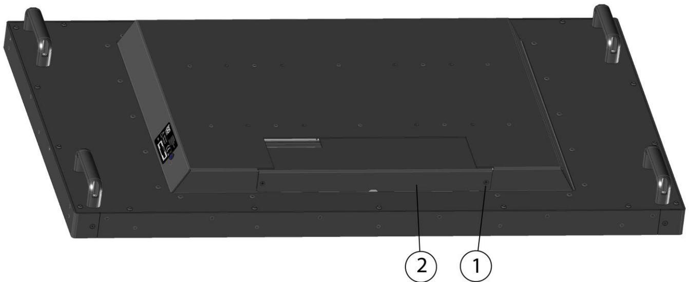
Démonter les 2 vis **rep.1** à l'aide d'un tournevis PZ1 et retirer le cache prise **rep.2**
