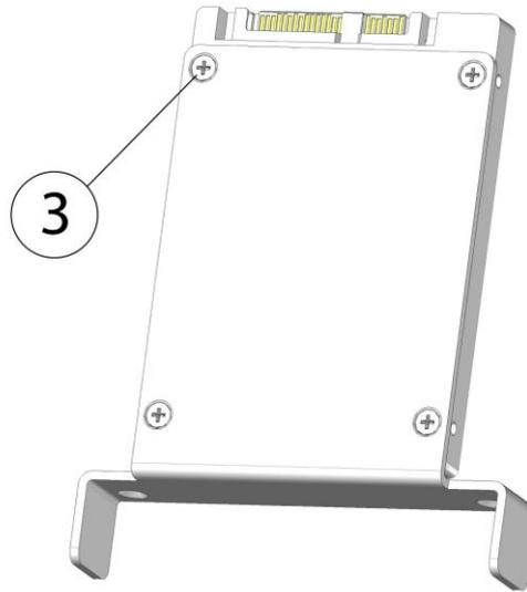
Démonter les 4 vis **rep.3** à l'aide d'un tournevis PZ1 pour enlever le disque dur.
