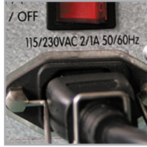
Anti-traction sur le câble d'alimentation
